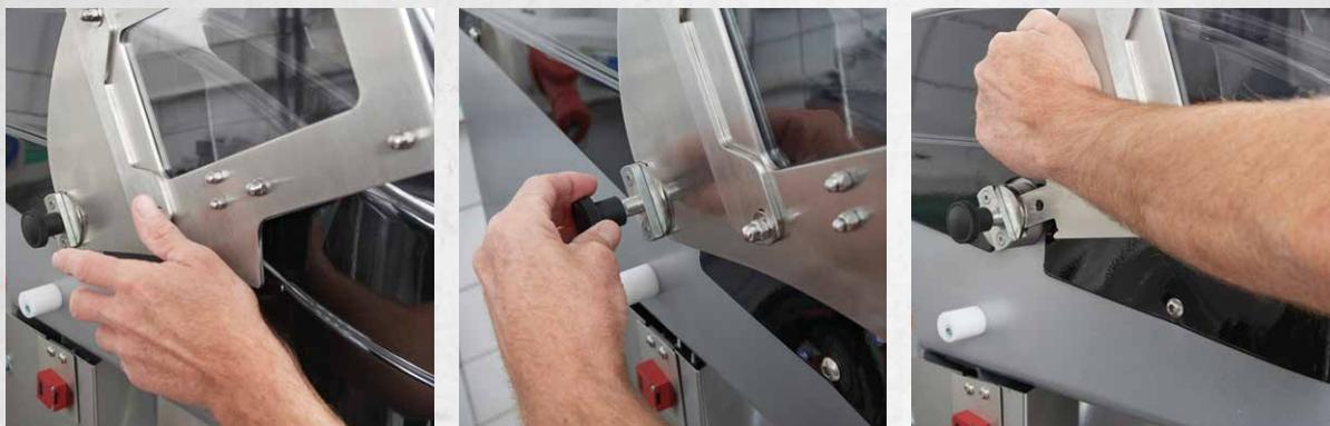
Con la tapa levantada, tire ligeramente y gire las perillas a cada lado de la **SATURNE EVO** para desbloquear el sistema. Sujete las partes metálicas de la tapa y tire de ella hacia usted.
